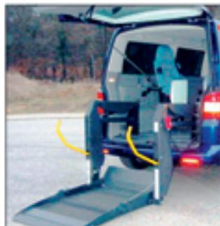
VW-T5 MIT LINEAR-KLAPPLIFT
