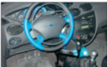
ELEKTR. GASRING (PATENTIERT) MIT BREMSE RECHTS
