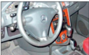
HANDBEDIENUNG FÜR GAS UND BREMSE RECHTS
